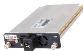
最大 50dB のダイナミックレンジ、最小のデッドゾーン、最適なデッドゾーン/ダイナミックレンジのバランスを実現した業界トップのパフォーマンスにより、長距離での中空コア認証を可能にします。
