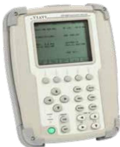
VIAVI IFR4000 フライトラインテストセットは、ILS、VOR、マーカービーコン、HF/VHF/UHF 通信 (NAV/COMM) システム、ELT 短距離緊急ビーコンおよび 406MHz COSPAS/SARSAT 長距離緊急ビーコンのテスト用に設計されています。メニュー方式の機能とガイド付きテスト機能により、この計測器は非常に使いやすくなっています。
