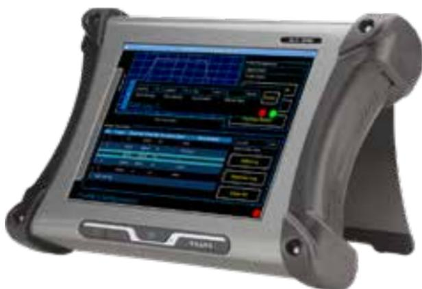
VIAVI ALT-8015は、世界初で唯一のRFベースのポータブル型電波高度計フライトラインテストセットです。軍事用途向けに設計されたALT-8015は、TX/RXアンテナからコックピットのインジケータまでをテストします。これにより、オペレーターは飛行中の状態を再現して、設置されたシステムの不良コンポーネントを分離できます。
