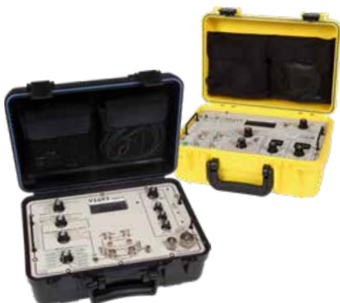
VIAVI 燃料量テストセットは、VIAVI 航空機固有のインターフェイスケーブルユニットと併用して、AC または DC 容量性燃料、水、LOX、またはエンジンオイルシステムを正確にテストまたはトラブルシューティングします。
