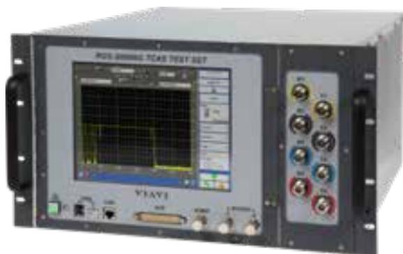
RGS-2000NG TCAS テストセットは、トランスポンダ LRU のテストに使用できるオプションを備えた、衝突防止警報装置 (TCAS) をテストするための RF 信号ジェネレータ/レシーバーです。RGS-2000NG は、最新のソフトウェア主導型デジタル変調技術を使用して設計されており、エンジニアリング開発、設計検証、製造、およびサービス復帰テストのための RGS-2000 の後継品です。
