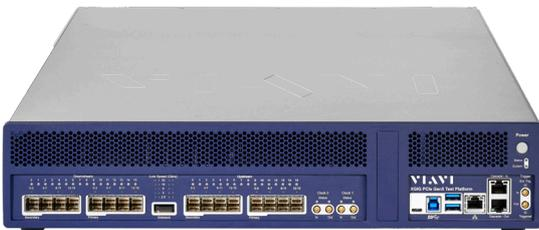
Xgig® 5P16 は、スタックのすべてのレイヤーで PCIe 第 5 世代 プロトコルトラフィックの分析を可能にするシステムプラットフォームです。この製品は、リンクとトランザクションのテスト、分析と高度なデバッグ、32 GTps までのリンク速度、最大 16 レーンまでの幅をサポートします。
