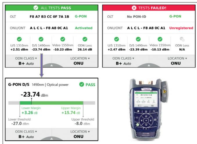
Bild 3: Messergebnisse mit dem TruePON Powermeter Viavi OLP-88
