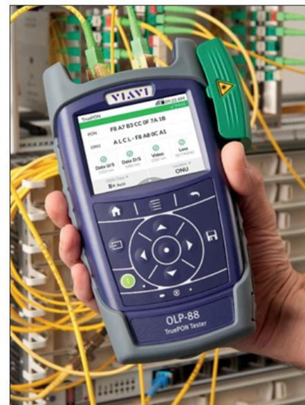
Bild 4: Das TruePON Powermeter OLP-88
