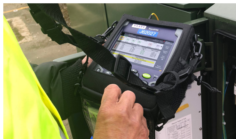
O engenheiro responsável pode visualizar remotamente a interface de usuário do OTDR de um técnico novato sem sequer levantar da cadeira
