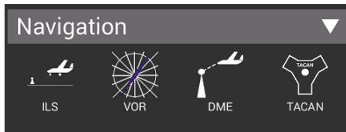
**ILS** – fornece sinalizador simultâneo (com DDM varrido), sinal de declive deslizante e sinalizador de marcador.
