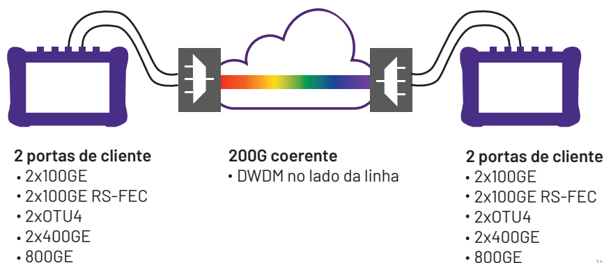
Teste de interconexão coerente de data center 200/400/800G
