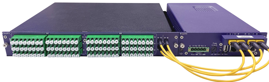
OTU-5000 com um TAP (ponto de acesso de teste) de 48 portas e chave óptica MPO de 48 portas
