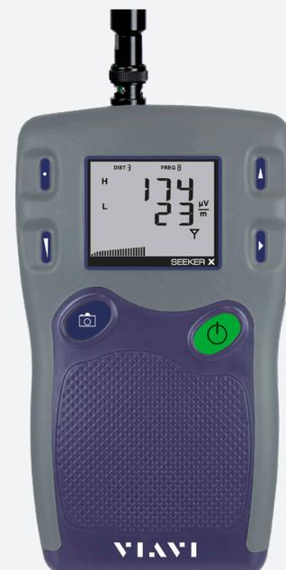
Os detectores Seeker X e os suportes móveis podem ser inseridos nos sistemas que usam atualmente Seeker D sem alterações nos processos de monitoramento e localização/correção existentes. Essas novas unidades Seeker X podem se beneficiar do aumento da velocidade, da sensibilidade e da detecção de OFDM por sua própria conta, além de monitorar duas frequências extras identificadas se os taggers CT-4 forem trocados por unidades CT-X compatíveis com Seeker D.
