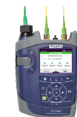
SmartClass Fiber OLP-88 (Certificador de Ativação PON) Medição de nível de potência PON, verificação de processo de ativação GPON ONT, identificação ONT/ONU, detecção rogue/alien-ONU e inspeção de conector com análise passa/falha
