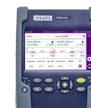
Optimeter G-PON/XG(S)-PON, modo de terminação, medidor de potência seletiva com certificação/troubleshooting de drop de fibra completa de última milha
