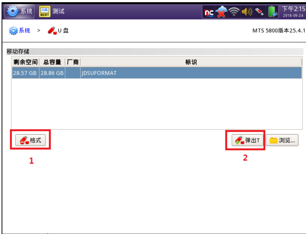
图 4，点‘格式’进行格式化，格式化完成之后点‘弹出T’
