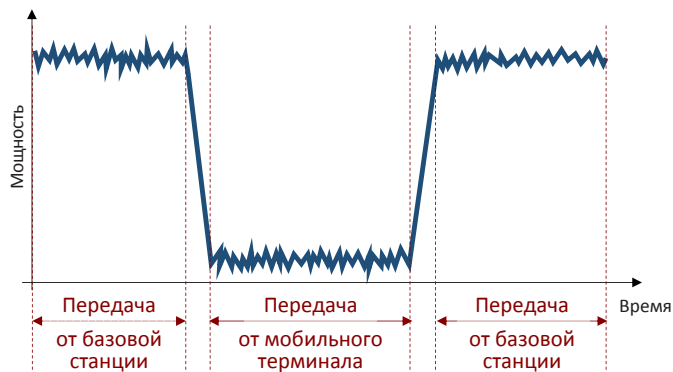
Рисунок 2. Структура сигнала LTE-TDD во временном интервале
