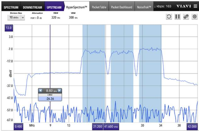
图 10. 带有实时和最大值迹线以及 DOCSIS 和脉冲噪声的 VSE-1100 超级频谱显示
