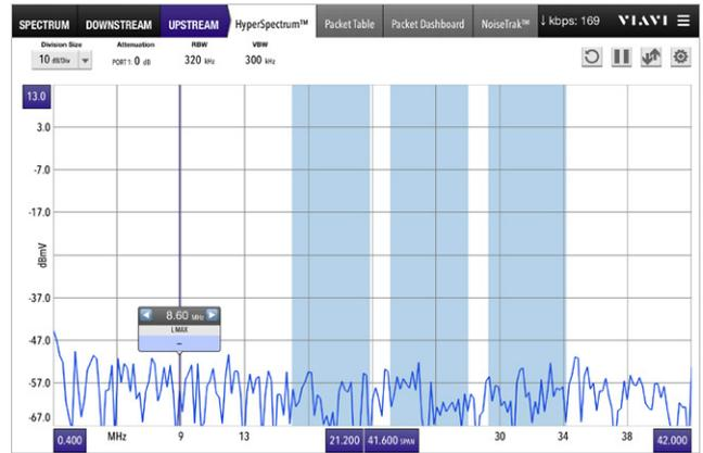
图 7. 显示脉冲噪声和 DOCSIS 载波的 FFT
