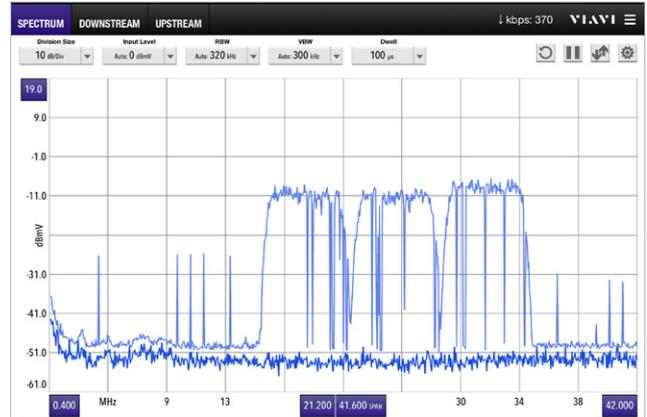
图4. 显示脉冲噪声和DOCSIS载波的扫频式频谱分析仪
