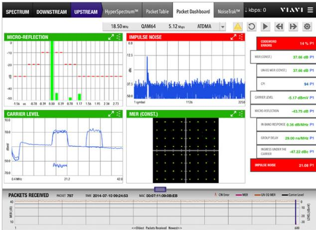
图 11. VSE-1100 数据包面板显示（包含导致码字错误的脉冲噪声）
