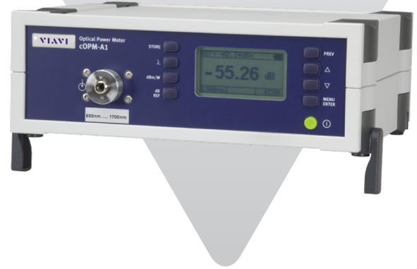
Viavi Solutions 紧凑型光学测试工具为光纤测试应用提供一系列新的单点解决方案。cOPM-A1 光功率计的优化设计适用于从一般实验室使用到测试以及无源光学元件的工序自动化。它既可用于单模光纤，也可用于多模光纤，功率电平为  $-80$  至  $+15$  dBm，波长范围为 800 至 1650 纳米。cOPM-A1 具有高精度、高线性和超低偏振相关灵敏度的特点。
