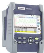
用于光纤网络测试的单槽位手持式模块化平台
