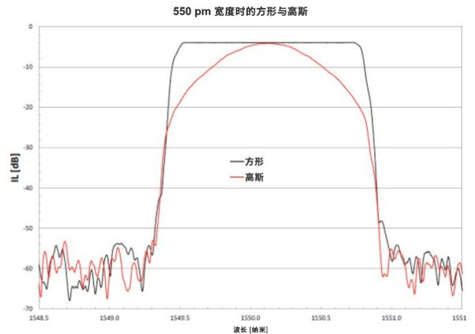
图 6 – 使用 mTFX 的方形和高斯滤波器
