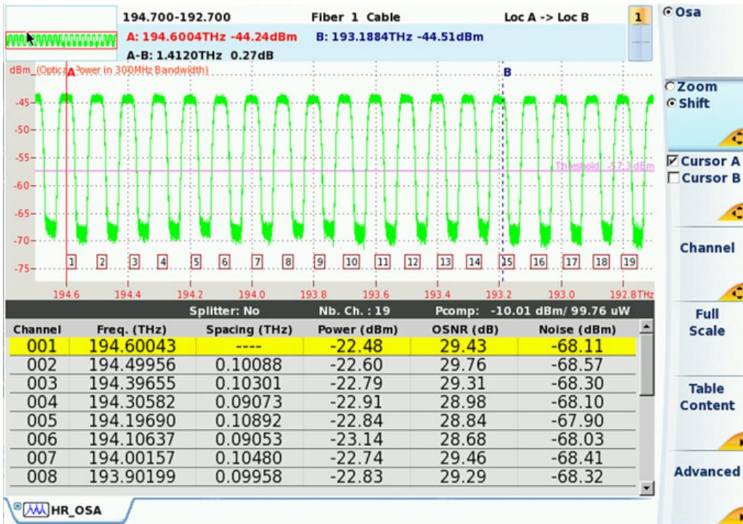
图 8 – HROSA 上显示的 mTFX 梳状滤波器的示例
