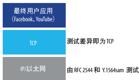
图 1. 简化的协议堆栈以及启动测试和最终用户体验之间的差异
