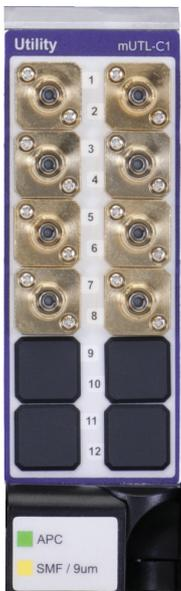
mUTL-C1 模块盒简化了测试设备的无源光学元件的机械集成。它们是高度可配置的, 包含无源光学设备, 例如分路器和抽头。它们支持角形或扁平抛光连接器以及单模和多模光纤。每个模块都有用户可定义的数据字段, MAP 系列机箱可以访问这些字段, 以帮助识别模块并远程显示或调用。
