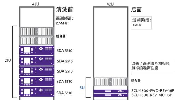
SCU-1800 节省机架空间，并且，16 个沟通与反向扫频的端口减少信号合路器的使用。
