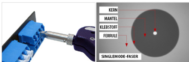
Abbildung 7: Prüfung durch den Einbausteckverbinder/Adapter mit dem Videomikroskop
